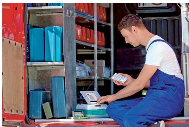
Obr. 5 Vďaka mobilnej tlačiarne s integrovaným softvérom a batériou vytvoríte spoľahlivé označenie priemyselných systémov vo vysokej kvalite priamo na mieste.
